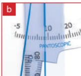
L'indicateur pantoscopique permet de relever directement la valeur de l'inclinaison de la monture.
